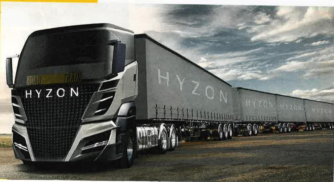
langer Sattelzug mit einem Gesamtgewicht von 140 Tonnen Güter durch die Lande fahren. Der für den Elektroantrieb des »Road Train« nötige Strom wird aus einer 370 Kilowatt-Brennstoffzelle stammen und soll angeblich für die enorme Fahrstrecke von 2000 Kilometern reichen.
