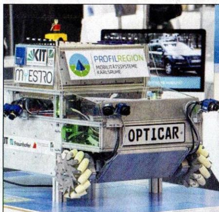
**SECHSMAL STEREO:** Kamera-paare schmücken den Demonstrator. Foto: KIT
