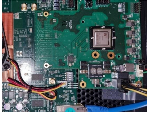
Abbildung 2 Tapeout des EPAC Beschleunigers auf der Testplatine
