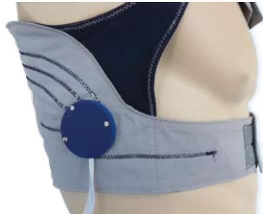
Textilintegriertes Tragesystem zur EKG-Ableitung
