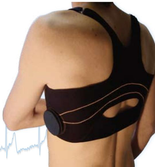
Textiles Aufnahmesystem für mehrkanaliges EKG
