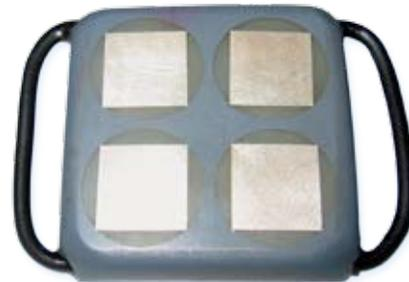
Geteilte Elektrode zur Messung der Elektrode-Haut-Impedanz
